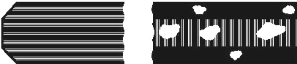
Рисунок А.2 — Грубошлифованная кромка
