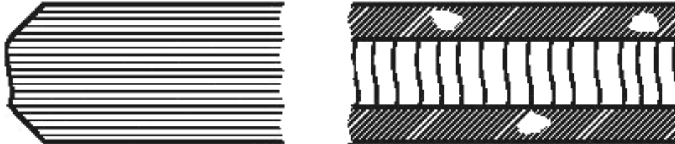
Рисунок А.1 — Притупленная кромка
