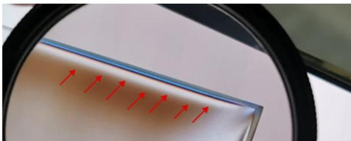
Закаленное стекло не поддается резке, сверлению или гравировке. Вследствие того, что после закаливания кромка по периметру остается «сырой», в редких случаях возможна дополнительная обработка кромки после закаливания на глубину 1-4 мм (зависит от толщины стекла).
